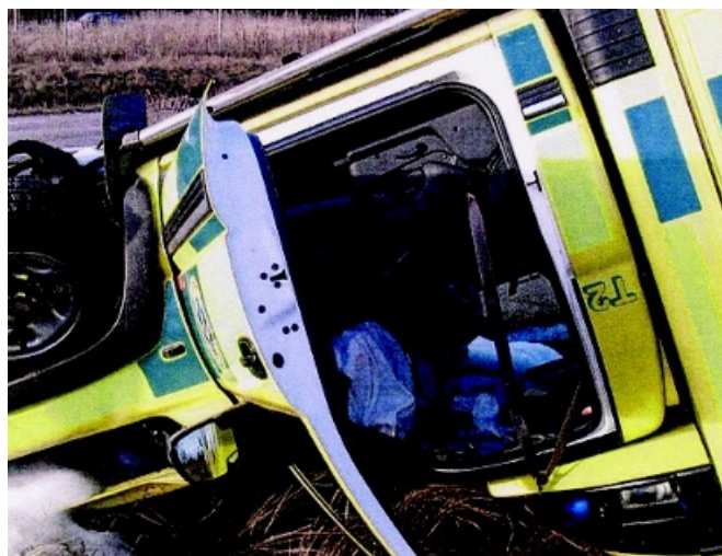
Figur 2. Förarutrymmet i en markbunden storbilsambulans som utsatts för ett s k roll over-moment i samband med en krasch under utryckning.
