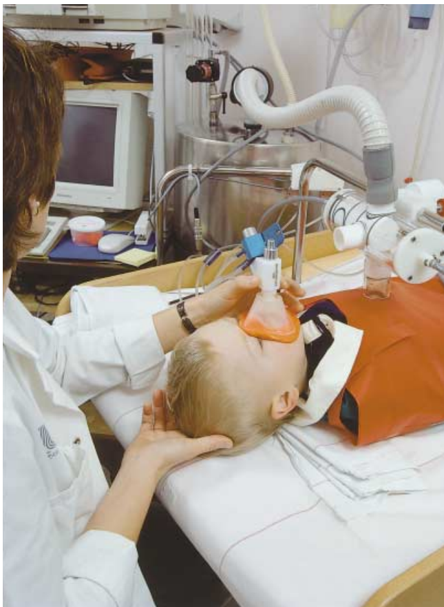
Figur 7. Ett barn undersöks med småbarnsspirometri. Se särskilt den uppblåsbara västen, tryckbehållaren med slangar kopplade till västen samt andningsmasken med utrustning för flödes- och tryckregistrering.
