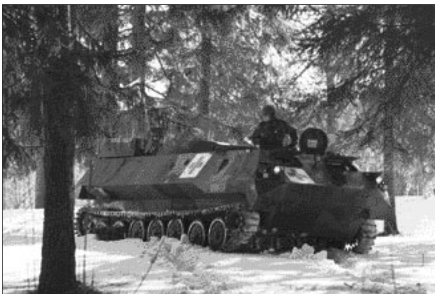
Figur 1. Splitterskyddande sjuktransportfordon (sjtppbv 4024) för evakuering av skadade från skadeplatsen till förbandsplats.
