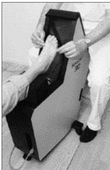
Figur 4. Digital laserskanning för tillverkning av fotbäddar.
