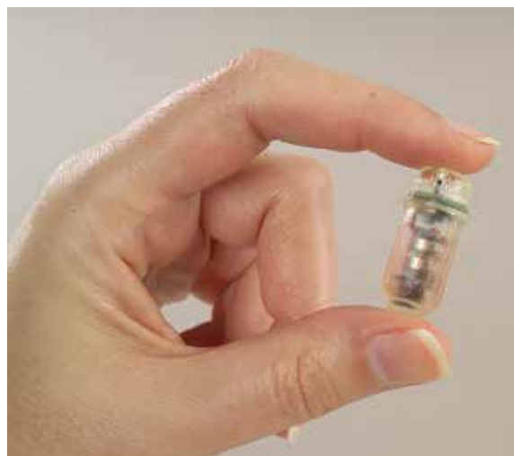
Figur 1. Gastrointestinal motilitetskapsel för mätning av pH, tryck och temperatur genom trådlös uppkoppling.
