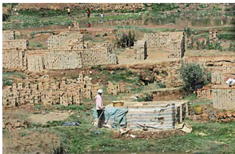
Figur 4. Manuell tegeltillverkning där teglet (en blandning av sand och lera) formas för hand och läggs att saltorka. Bilden är från Madagaskar, men samma teknik används i många fattiga länder.
